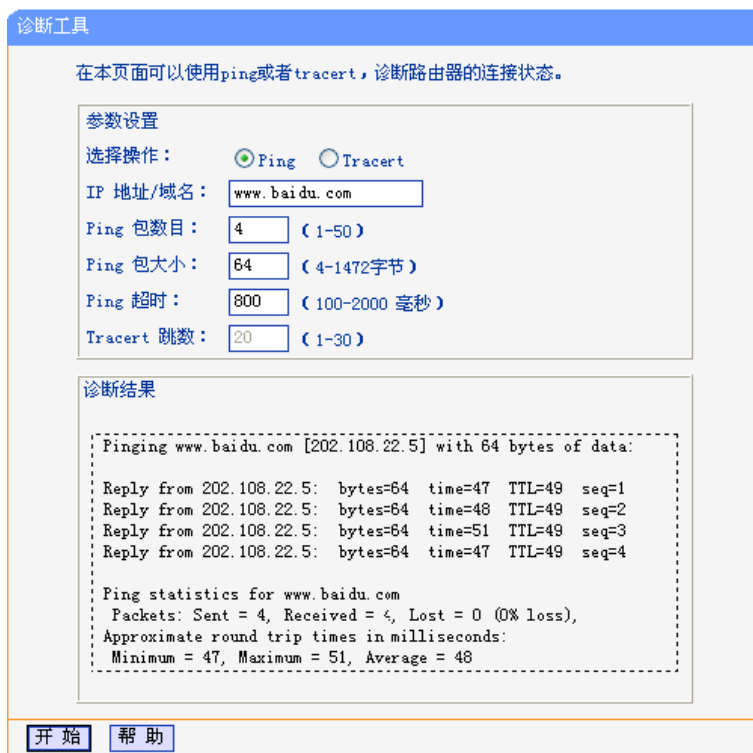
图 6-38 Ping 诊断结果—成功
