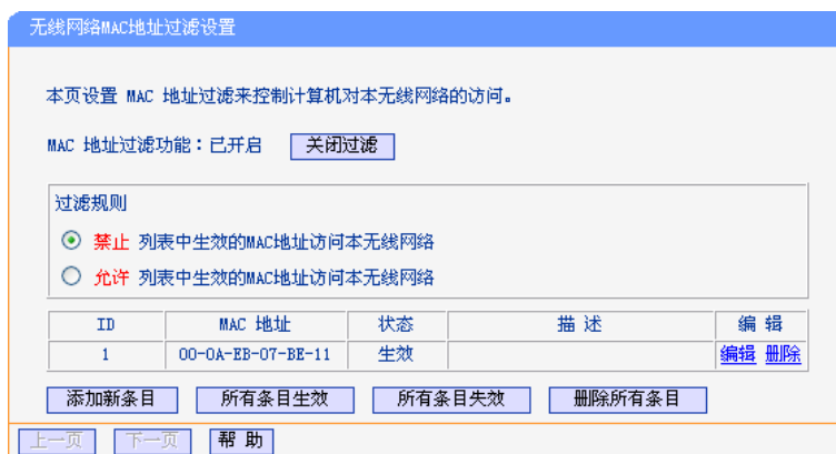
图 5-26 无线网络 MAC 地址过滤设置
