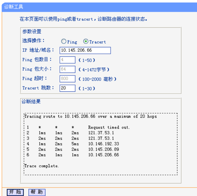
图 5-76 Tracert 诊断结果—成功
