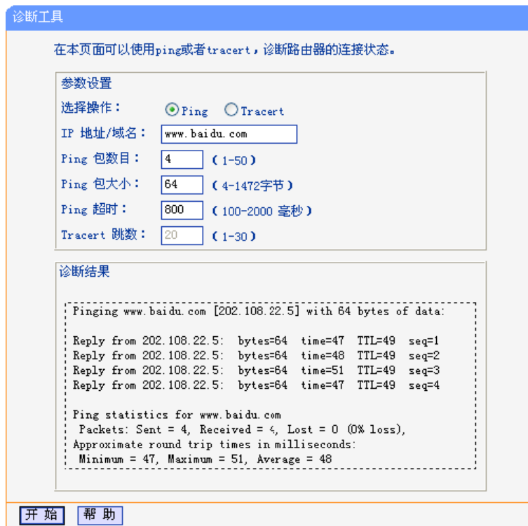
图 5-74 Ping 诊断结果—成功
