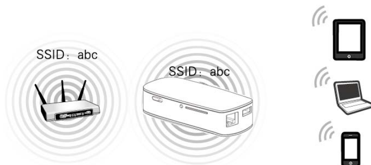
图 4-4 Repeater 模式连接图
