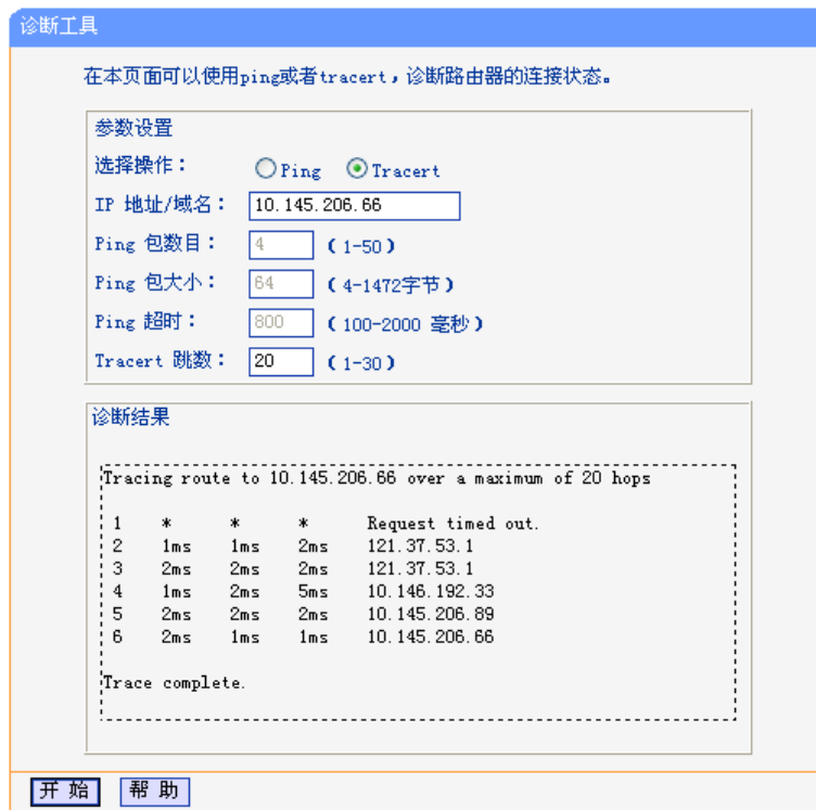
图 6-40 Tracert 诊断结果—成功
